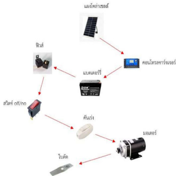
(ข) ระบบการทำงานของเครื่องตัดหญ้าพลังงานแสงอาทิตย์
