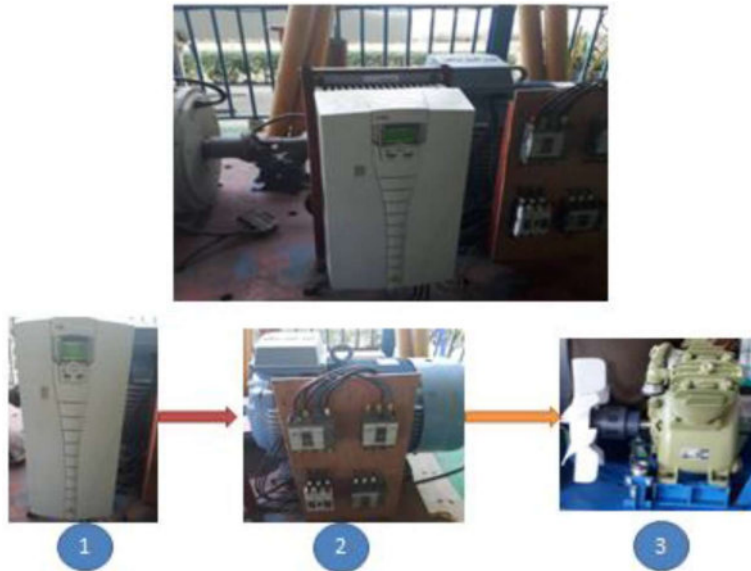
ภาพที่ 5 ระบบการทำงานของเครื่องอัดอากาศที่รอบทำงานต่างๆ
