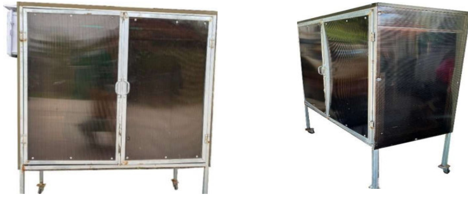
ภาพที่ 2 ต้นแบบตู้อบเสื้อผ้าวินเทจด้วยหลอดไฟ UVC
